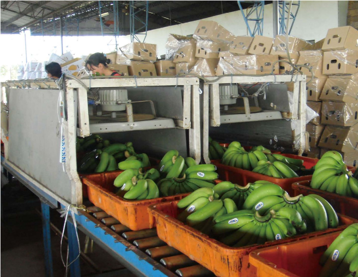
圖 24 風扇吹乾果軸避免蕉乳流出
