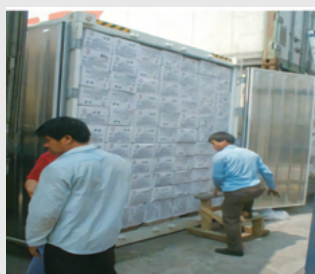
● 圖 35. 裝貨過滿阻礙冷氣循環
