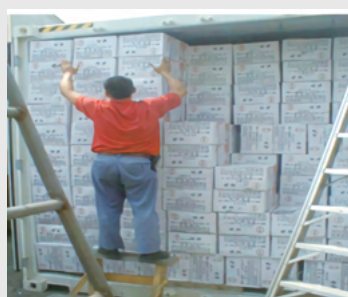
● 圖 34. 裝貨過滿阻礙冷氣循環
