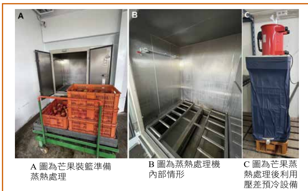
圖53 小型蒸熱處理機，目的為抑制炭疽病。
