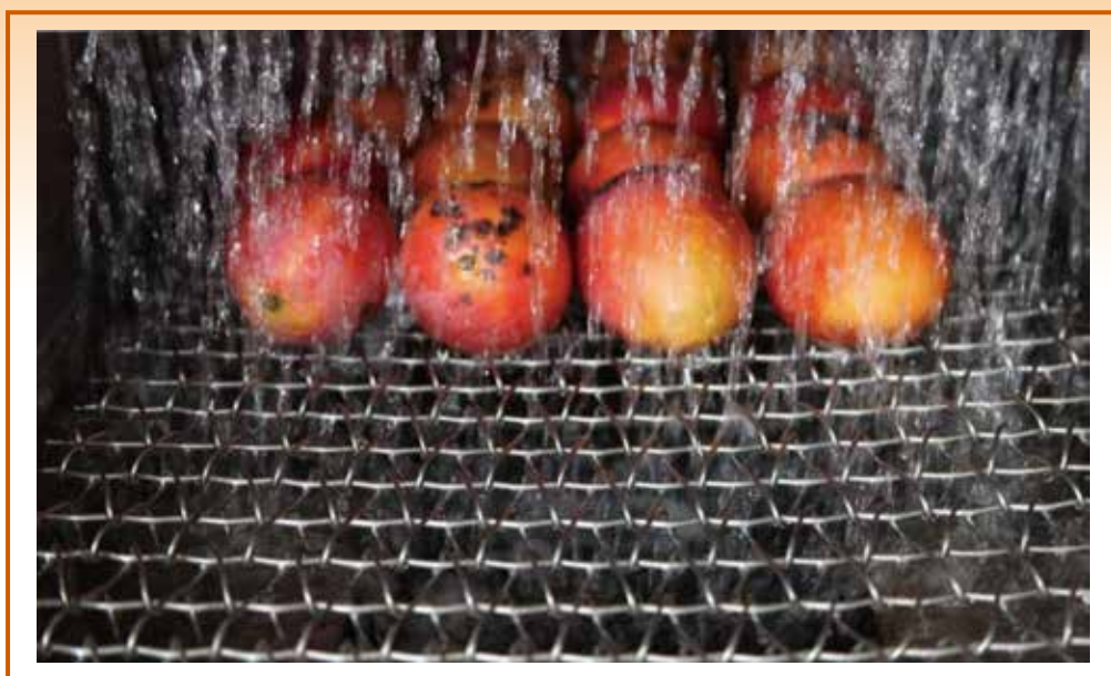
圖52 芒果淋洗式溫湯處理作業（鳳山熱帶園藝試驗分所 邱國棟主任提供）
