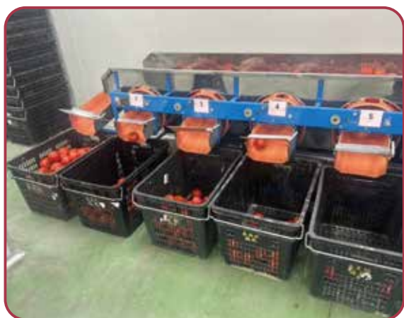
圖30 集貨場的滾筒式自動分級
